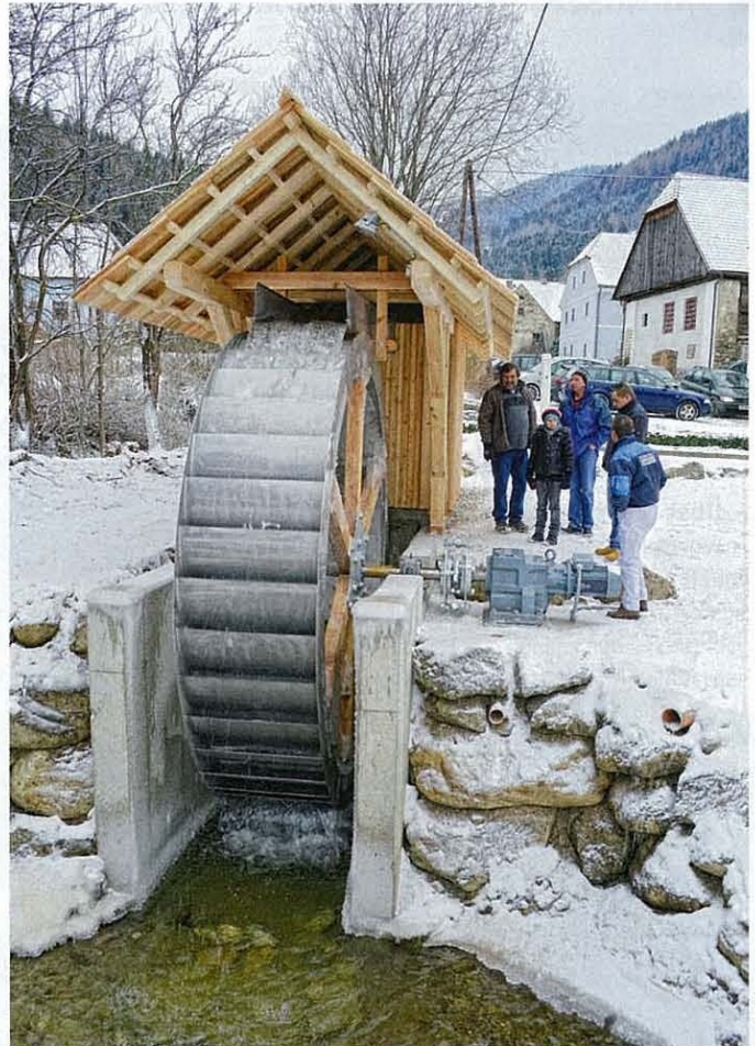
500 Liter Wasser pro Sekunde betreiben das Wasserrad am Wöllbach.
